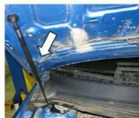
4. Прокачать амортизатор (упереть в твердую поверхность, несколько раз полностью сжать и отпустить).
