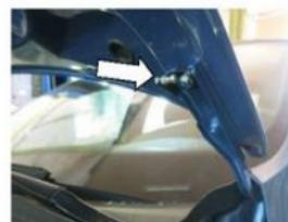
3. Открутить верхнюю гайку крепления крыла. Установить кронштейн капота, уперев его в ребро жесткости. Затянуть гайку ключом №13 с усилием 23 Нм.
